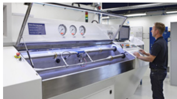
Zkušební zařízení (stendy) pro zkoušení průtoku hydraulického oleje a vody, kapacita do 300 l/min.
